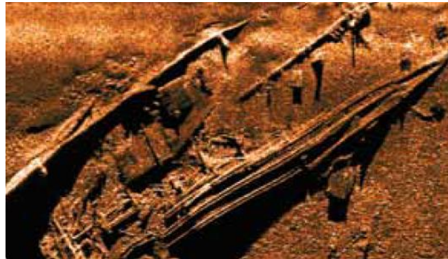
Figura 29: Imagem do side scan sonar mostra uma embarcação naufragada.
