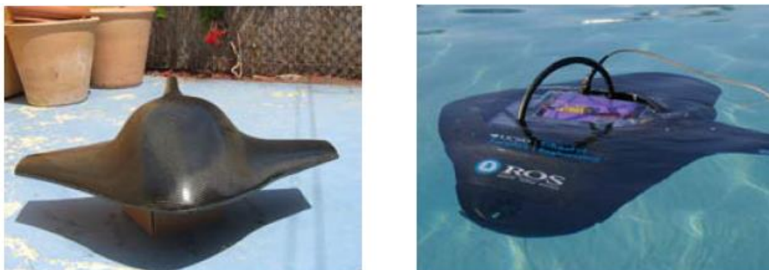
Figura 51: Casco de fibra de carbono e Stingray finalizado com a tampa aberta.
