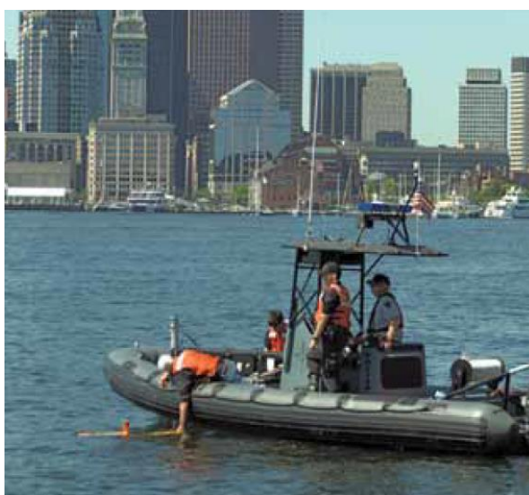
Figura 28: O Bluefin-9 pode ser facilmente lançado e recuperado utilizando um bote inflável.
