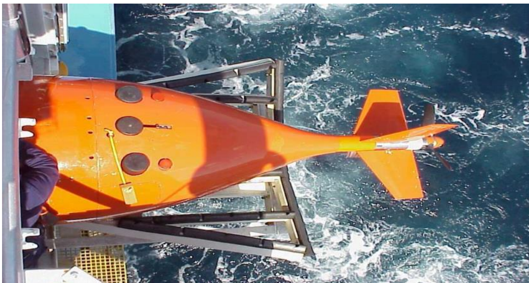
Figura 11: Foto da parte traseira de um AUV com seu sistema de propulsão.
