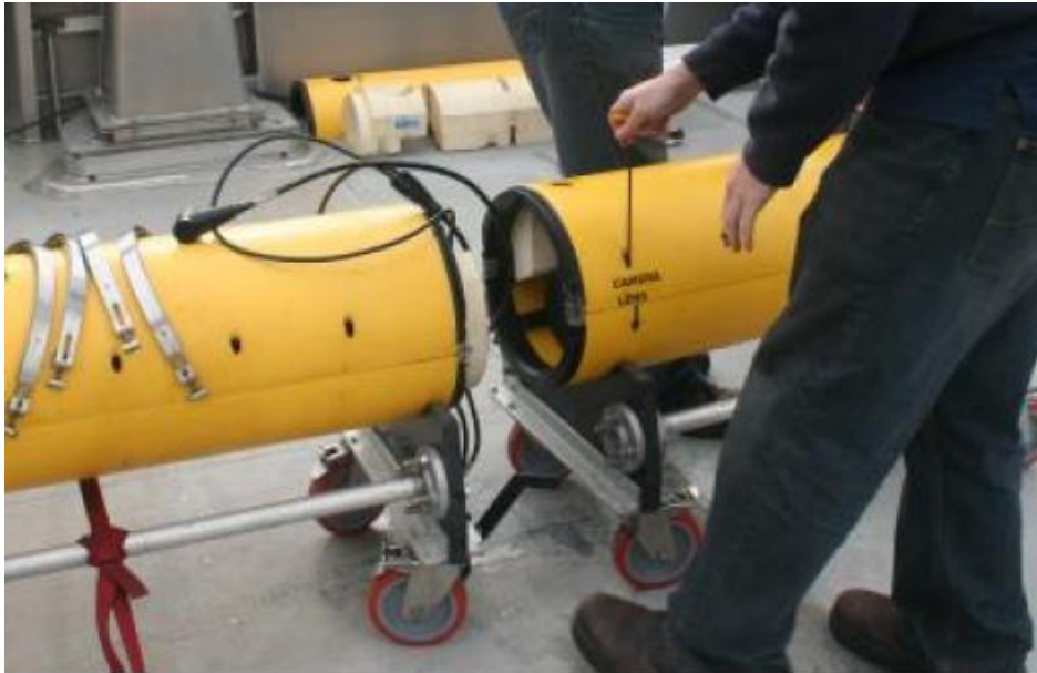
Figura 12: Foto mostrando a estrutura modular do veículo.
