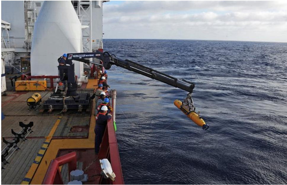
Figura 66: O AUV Bluefin 21 sendo lançado para sua primeira missão, em 14 de abril.
