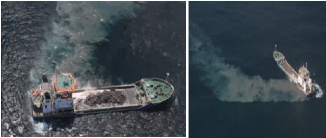
Figura 21. Embarcações realizando o despejo do material dragado do interior da Baía diretamente no ponto de estudo C.
