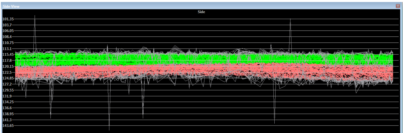
Figura 12 - Imagem que mostra as duas faixas de feixes geradas pelo ecobatímetro após a limpeza de spikes para dada área da linha analisada.
