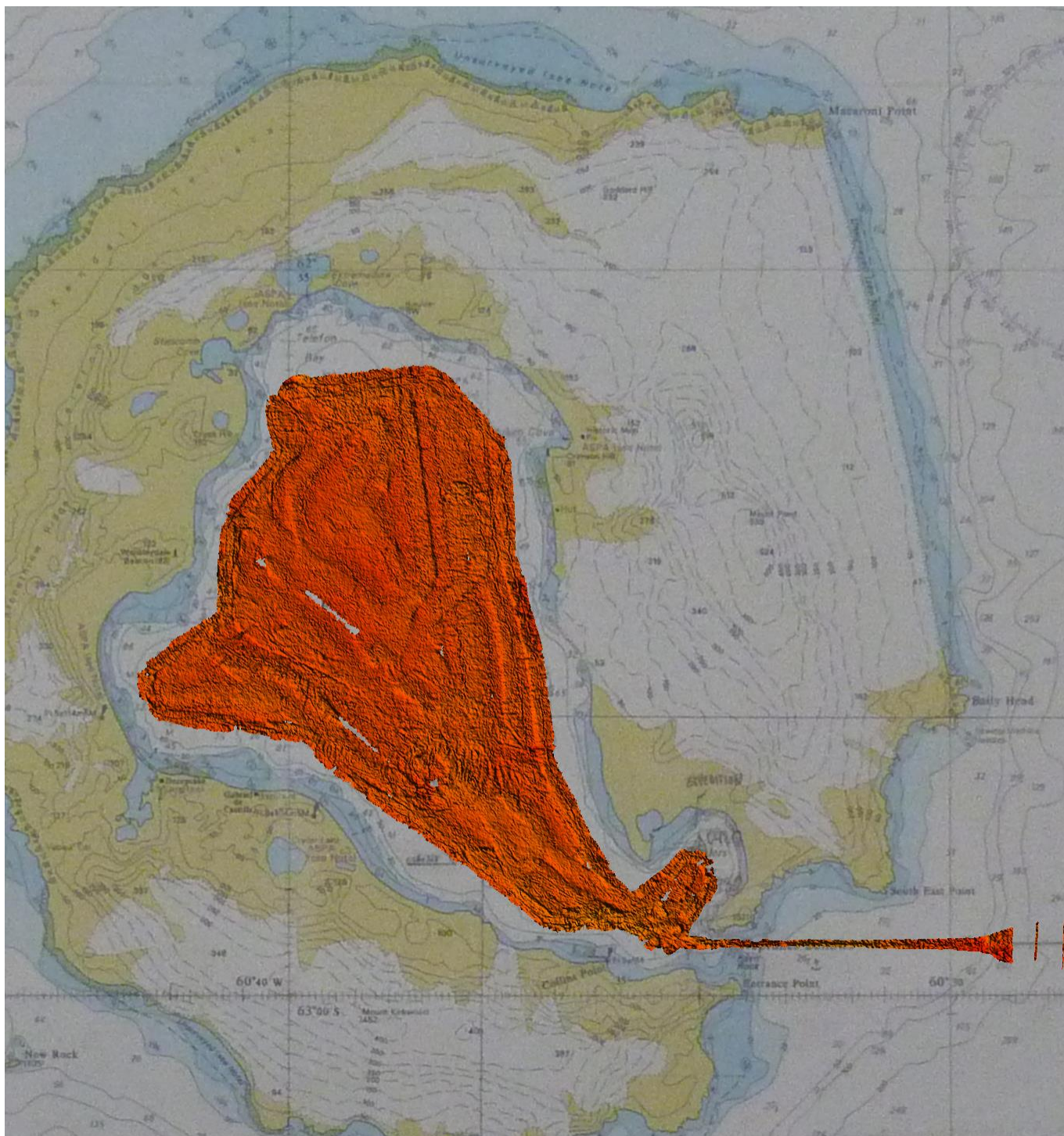
Figura 30 - Mosaico final para a caracterização dos valores de intensidade backscatter da região.
