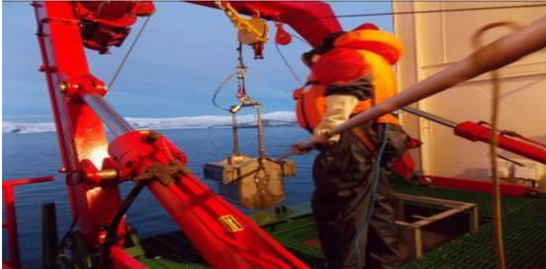
Figura 20 - Equipamento Box Corer em preparação para ser utilizado para coletar amostras de fundo na Ilha de Deception. (Fonte: Relatório de campo - OPERANTAR XXXII).
