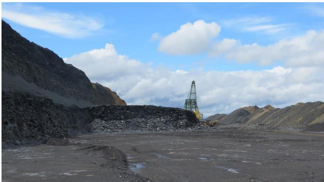
Figura 22: Máquina (dragline) responsável pela retirada da camada referente a Formação Serra Alta (cobertura) para que seja possível a extração das camadas inferiores de folhelho preto da Formação Irati. Pode-se perceber a remoção ocorrida do lado esquerdo e a deposição do resíduo no lado direito, deixando livre o folhelho preto para ser minerado.
