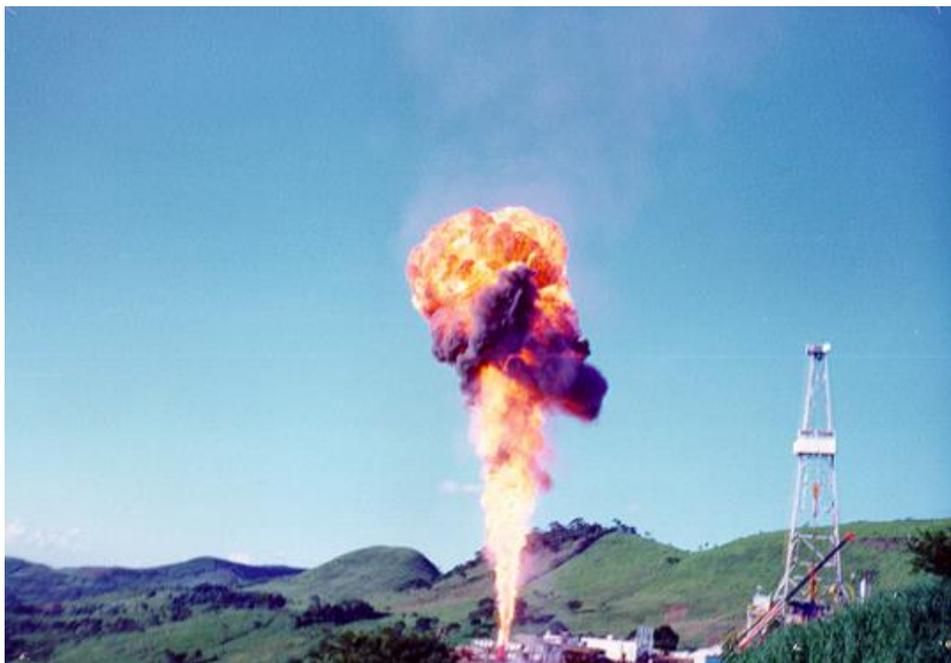
Figura 18: Teste de poço no campo de gás de Barra Bonita (ANP).
