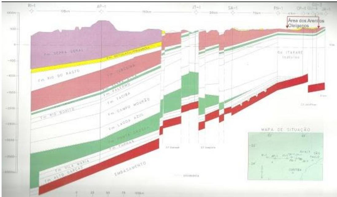
Figura 24: Seção geológica da Bacia do Paraná, indicando a área dos arenitos oleíferos (Modificado de Araújo et. al. 2000).
