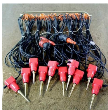
Figura 6 - Conjunto de receptores terrestres, chamados de geofones
