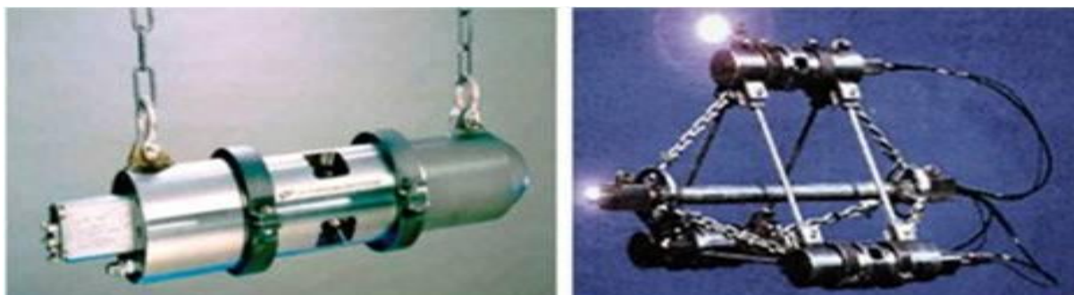
Figura 3 - Imagens referentes à fonte sísmica marinha air gun : único equipamento a esquerda e um arranjo com três air guns a direita
