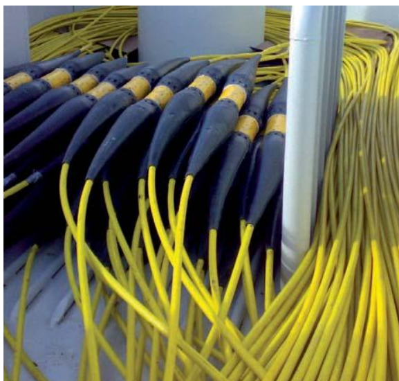
Figura 4 - Arranjo com diversos hidrofones ao longo de um cabo, denominado streamer
