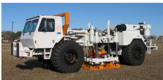
Figura 5 - Fonte sísmica terrestre conhecida como vibroiseis
