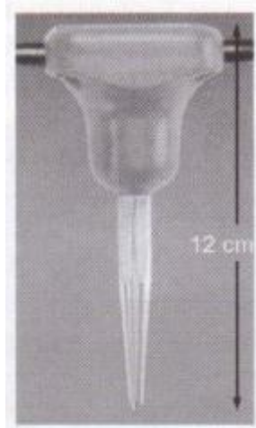
Figure 8. Um dos vários modelos de geofones utilizados em levantamentos terrestres. Fonte: Triggia et. Al. (2001)
