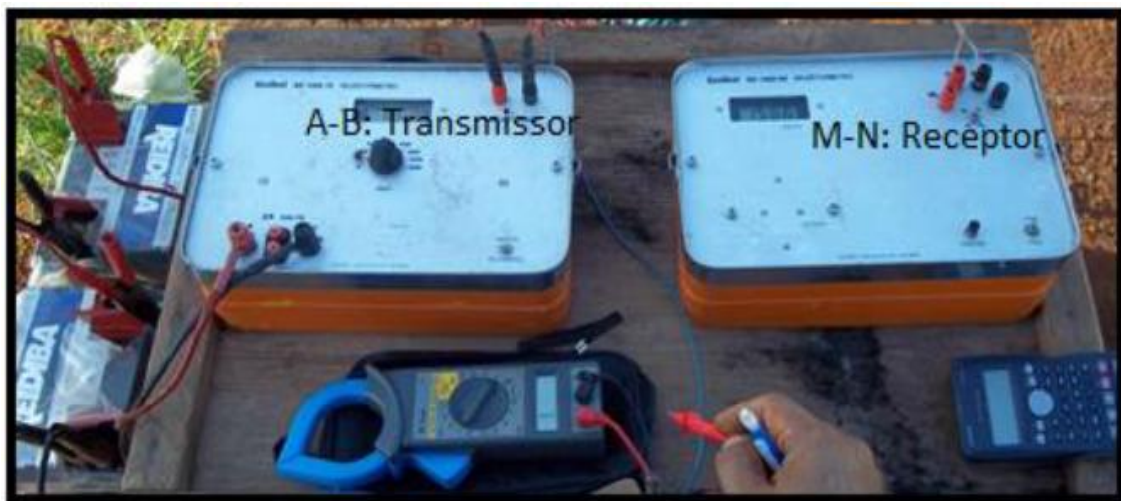
Figura 31: Resistímetro GEOTEST RD 1000 A. Fonte: Duarte et al. (2014)
