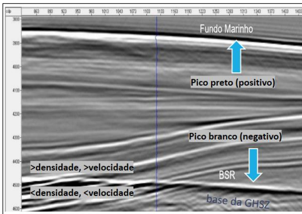
Figura 8: Seção sísmica empilhada, com destaque para o BSR. Notar a inversão de polaridade entre o BSR (pico branco) e o fundo do mar (pico preto). Modificado de Pintas, 2011.
