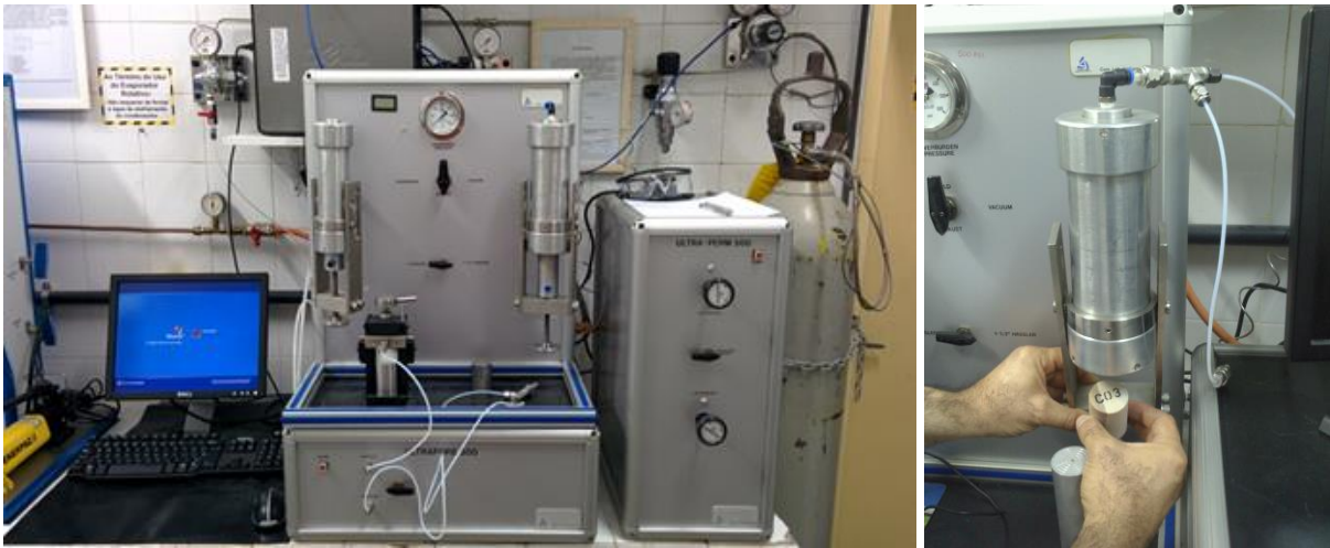
Figura 3.1.2: a) Foto do porosímetro ULTRAPORE 300, com o permeametro ULTRAPERM 500 no laboratório de petrofísica do UFFLAR; b) Célula Hassler em destaque, acoplada ao dois equipamentos.
