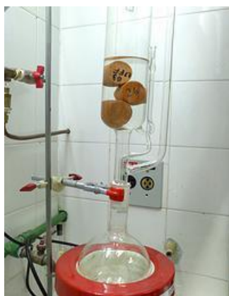
Figura 3.1.1: Extrator Soxhlet fazendo a limpeza de 3 amostras.
