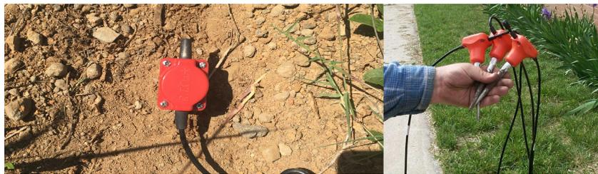
Figura 4 – Geofone da empresa *Geometrics Inc.*. À esquerda, já implantado ao solo para aquisição e à direita, apresentando a estrutura que o fixa e faz a captação do dado. (Fonte: *Kansas Geological Survey*)
