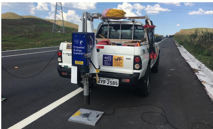
Figura 1 – Fonte empregada no levantamento deste trabalho, que utiliza uma espécie de martelo acelerado por um gatilho e que impacta a placa metálica para gerar a onda mecânica.
