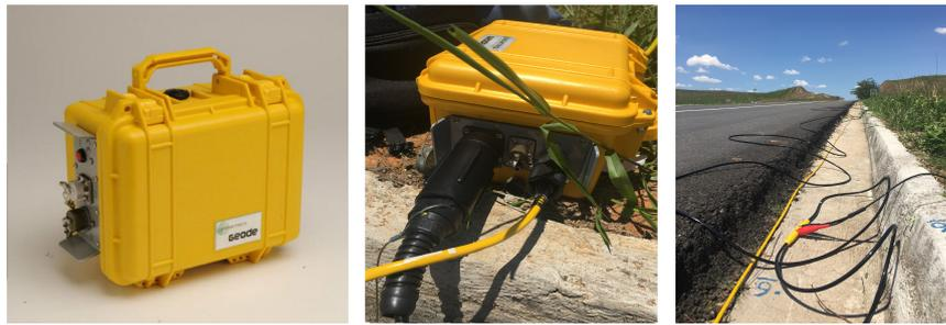
Figura 3 – Geode: Sismógrafo da empresa *Geometrics Inc.*. À esquerda e ao centro, sua estrutura e à direita, imagem dos cabos que ligam os geofones ao sismógrafo.
