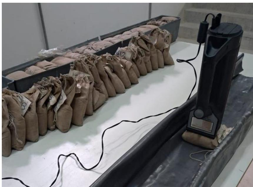
**Figura 17.** Configuração da aquisição, mostrando uma amostra de calha no centro da manta de chumbo e o gamaespectrômetro em funcionamento sobre a amostra.
