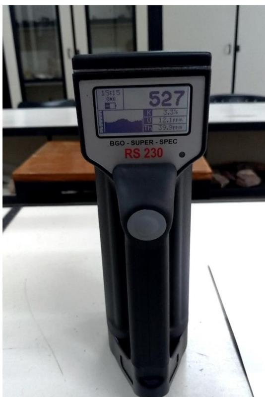
Figura 10. Gamaespectrômetro portátil RS-230.
