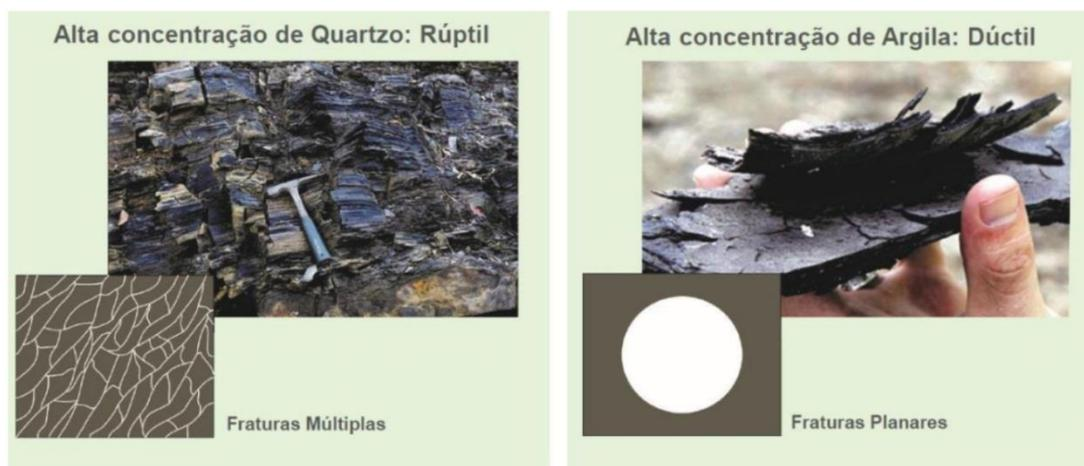
**Figura 5:** Diferença entre fraturas em folhelhos ricos em quartzo (rúpteis) e ricos em argila (dúcteis). Fonte: ABELHA (2016).
