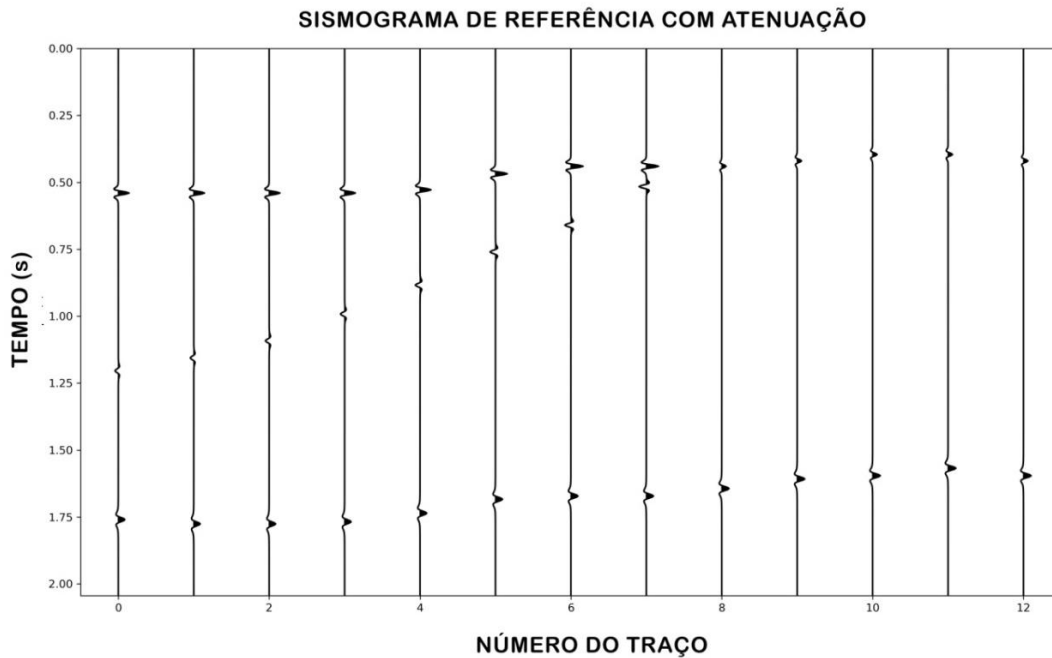
Figura 15: Sismograma sintético gerado a partir do modelo geológico de pinch out com aplicação do efeito de atenuação com Q constante de 150 ao longo de todo o modelo.
