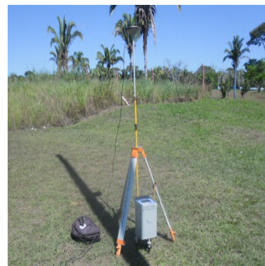
(b) Aquisição terrestre com o Autograv-CG5 junto ao GPS Trimble utilizado para mensurar as coordenadas plani-altimétricas. Retirado de: Topocart.
