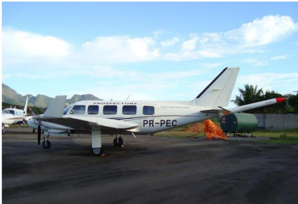
Figura 10 – Exemplo de um avião utilizado no aerolevantamento com sistema de aquisição magnética acoplado na cauda. (Fonte: Arquivo pessoal.)
