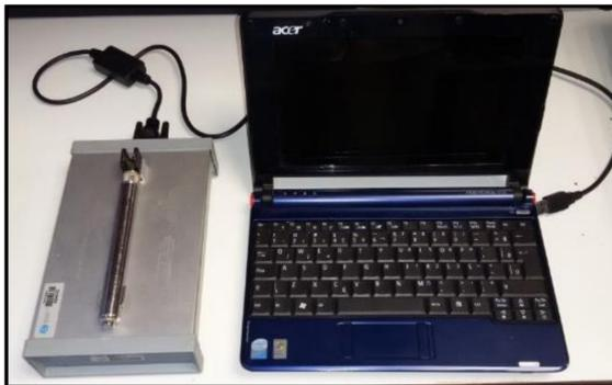
Figura 6 – Transferência de dados de campo da sonda para o computador portátil. Fonte: Imagens cedidas pelo Laboratório de Geotermia do Observatório Nacional.
