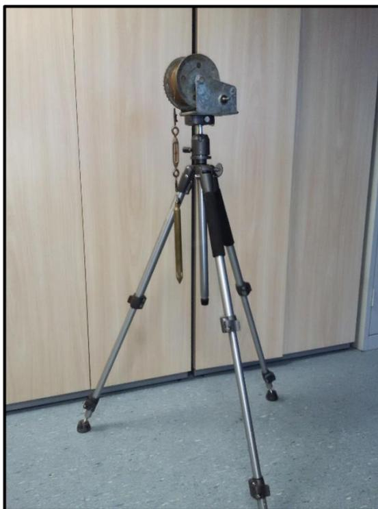
Figura 5 – Arranjo em campo para medições de temperatura em poços. Fonte: Imagens cedidas pelo Laboratório de Geotermia do Observatório Nacional
