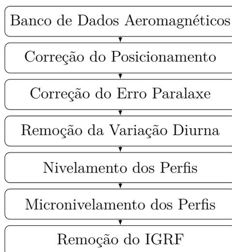
Figura 17 – Fluxograma do processamento de dados aeromagnéticos.
