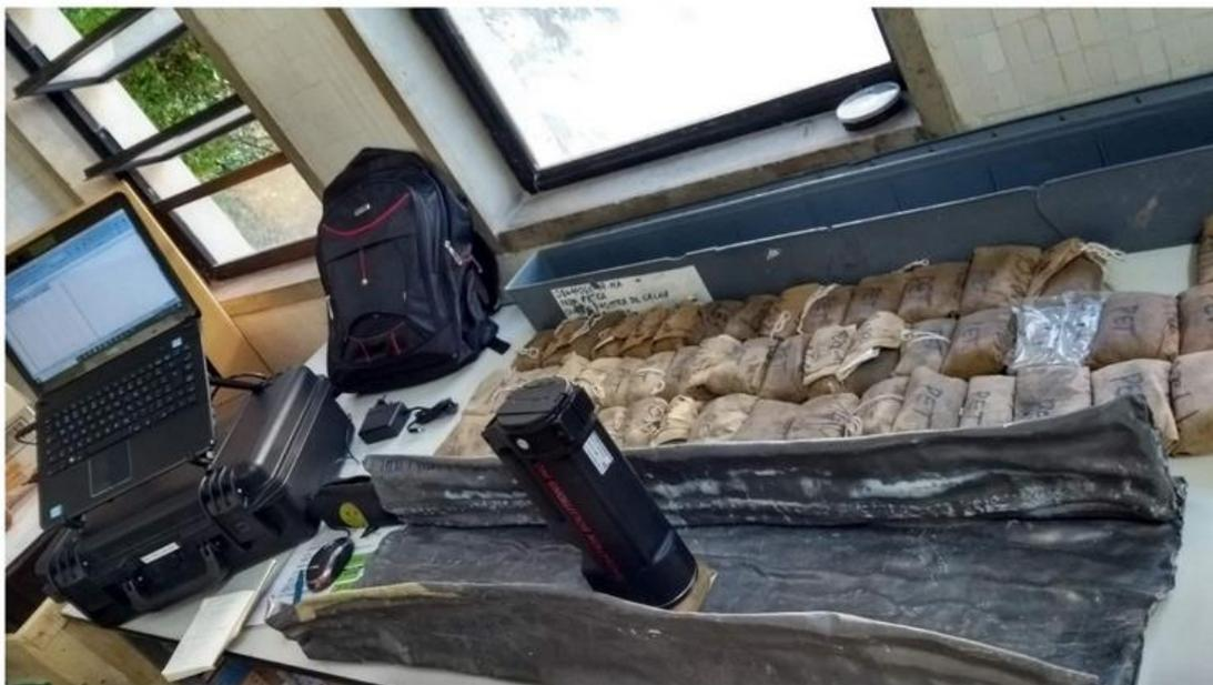
Figura 18: Ambiente de trabalho de aquisição de dados; equipamento e amostra dentro da malha de chumbo (Fonte: Do autor).
