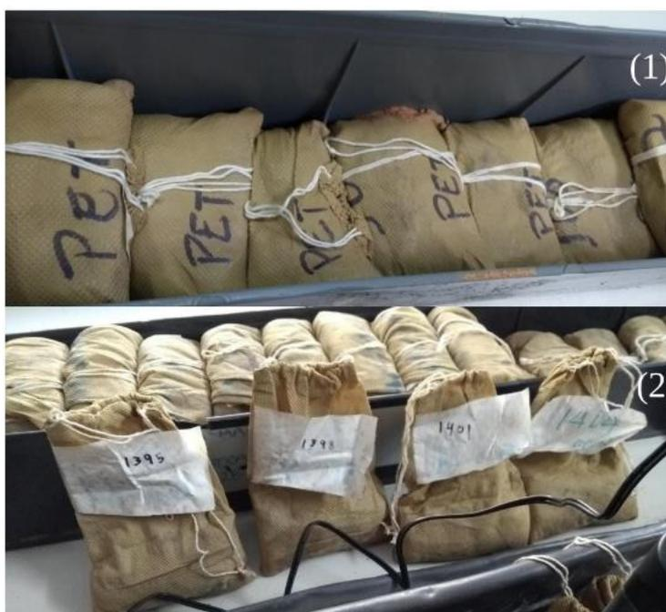
Figura 12: Representação da disposição das amostras de calha na caixa (1) e exemplificação da numeração de cada amostra correspondente à profundidade de perfuração (2). Fonte: Do autor.
