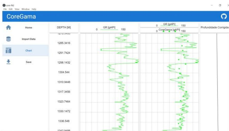
Figura 24: Curva verde GR corrido em poço aberto; Pontos Total Gama de laboratório. Ambiente do Software de ajuste de profundidade (Fonte: Do autor)
