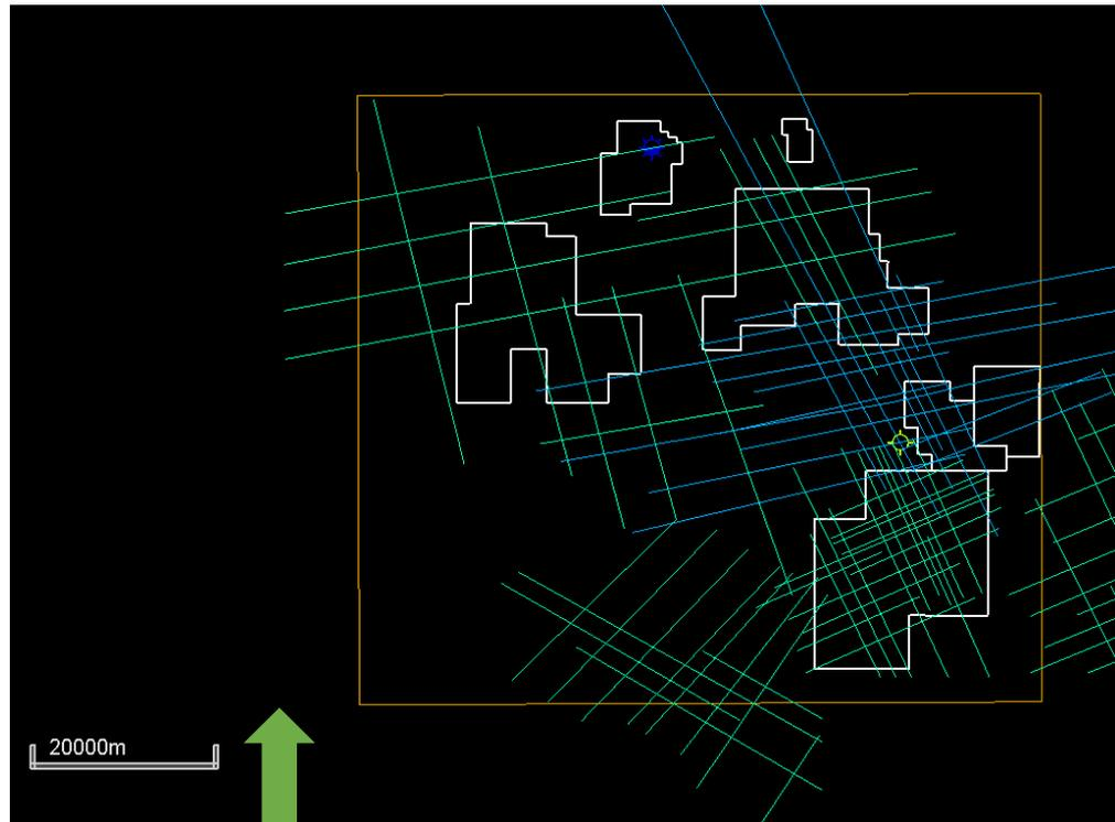
Figura 39: Região de cobertura dos dados utilizados no estudo. As linhas verdes e azuis representam a malha sísmica 2D, os polígonos brancos representam os *ring fences* de produção da área do parque dos gaviões, o poço azul é o *header* do poço 3-PGN-5-MA, poço verde é o *header* do poço 4-OGX-49-MA, o polígono laranja representa a área focada para o estudo.
