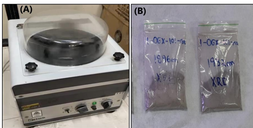
Figura 35 - (A) Moinho utilizado para homogeneizar a granulometria das amostras. (B) Amostras coletadas após moagem. Fonte: Autor.
