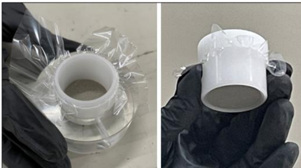
Figura 32 - Cápsulas de plástico utilizadas como recipiente adequado para as análises no XRF. A base do recipiente é o contato entre a amostra e o leitor do equipamento. Fonte: Imbuzeiro (2021).
