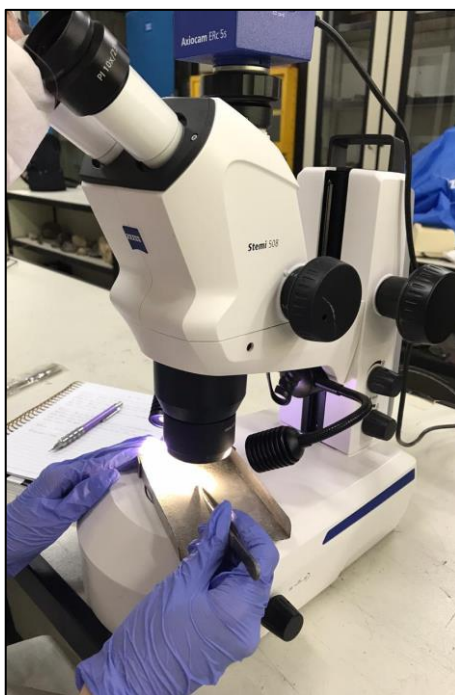
Figura 30 - Estereoscópio Binocular – Stemi 508, utilizado na descrição das amostras de calha. Fonte: Equipe do Projeto Parnaíba.
