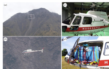
Figura 25 – a) Vista panorâmica do vulcão Unzen, Japão.com a posição do helicóptero que transporta o instrumento, o retângulo branco indica a posição do helicóptero; b) Imagem do helicóptero visto na alínea a); c) Helicóptero sem instrumento; d) Helicóptero carregado com o instrumento.
