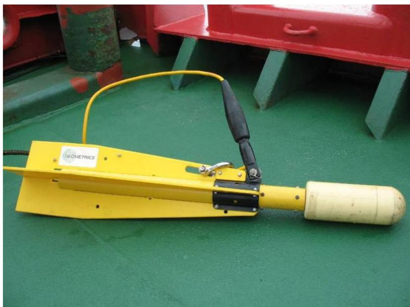
**Figura 14:** Magnetômetro de precessão de Prótons Geometrics.
