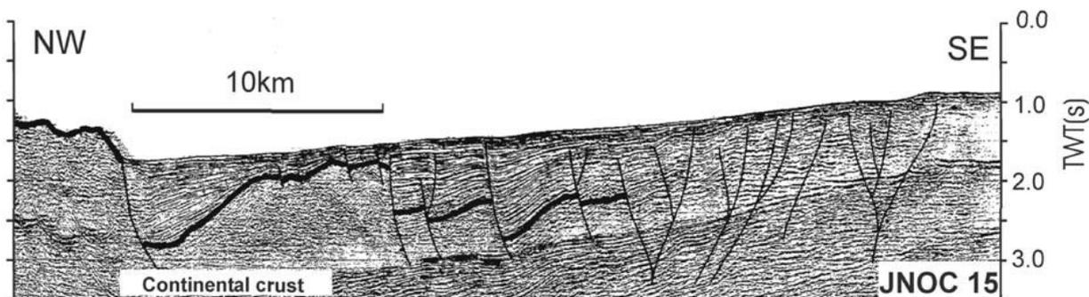
**Figura 10:** Perfil de sísmica multi-canal mostrando as principais estruturas oeste da Bacia de Bransfield. Fonte: Galindo-Zaldívar, 2006.
