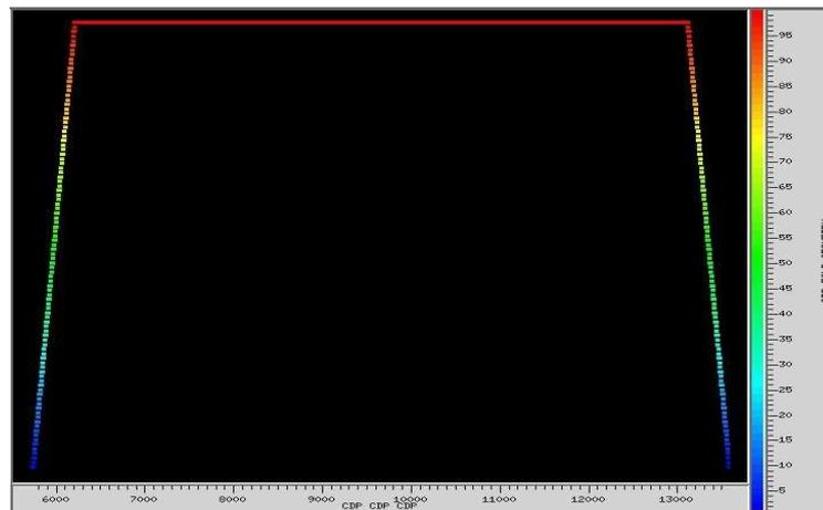
Figura 4.3: Cobertura *CMP*, cobertura nominal máxima de 100 traços por posição (full fold).
