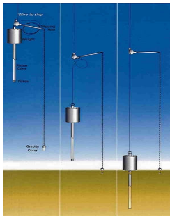
Figura 12: mecanismo de aquisição - piston core . Fonte: http://oceanworld.tamu.edu
