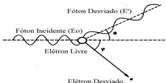
Figura 5 - Diagrama esquemático do Efeito Compton. O fóton incidente transfere uma parte de sua energia  $E_0$  para um elétron e um fóton de energia reduzida  $E'$  deixa o local da colisão obliquamente à direção de incidência. (Modificada de Bassiouni, 1994).
