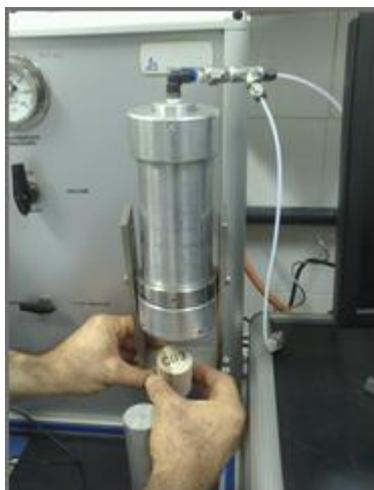
Figura 1: Célula Hassler acoplada ao porosímetro Ultrapore-300 e permeâmetro Ultraperm-500. Fonte: <http://www.ufflar.com/>
