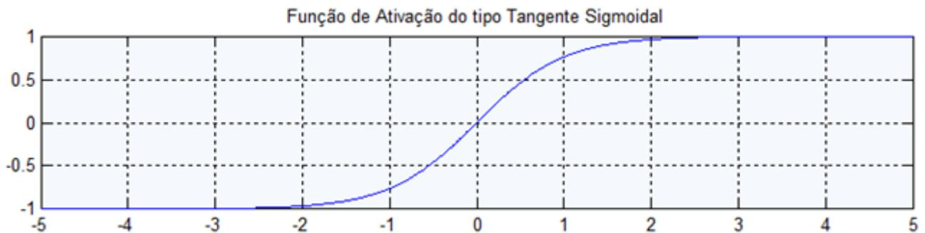
Figura 15- Função de ativação do tipo tangente sigmoidal.
